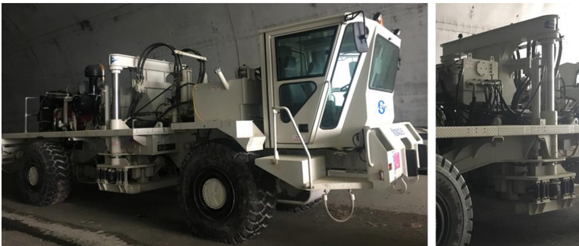
Abbildung 3: VibroScan ® , Elektrohydraulischer Schwingungserregger Nomad 65.
