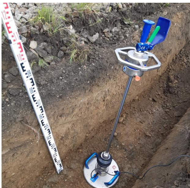
© iC/ Dynamischer Lastplattenversuch im Baggerschurf
