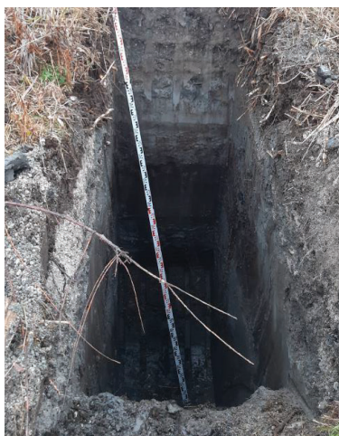
© iC group / Weicher Seeton beim Aushub der Baggerschürfe
